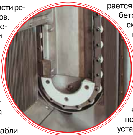
Ролики нержавеющей цепи и нижние направляющие изготовлены из современного износостойкого полимера с низким коэффициентом трения
